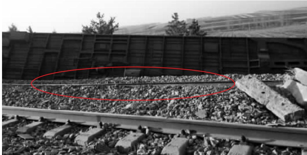
一条12米长的铁轨完整地脱离原有轨道。
