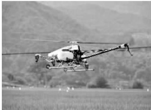
无人旋翼植保飞机。 通讯员 夏超明 摄
