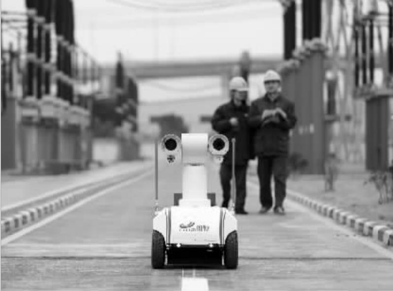
昨天,一个小小的智能机器人完成了对220千伏洪塘变电站的巡视和检查。这是供电部门首次运用智能机器人对变电站进行自动巡视和检查。这台智能机器人搭载有移动高清相机、红外热像仪和各类环境传感器,所到之处,变电站很多设备的情况它都能掌握。
