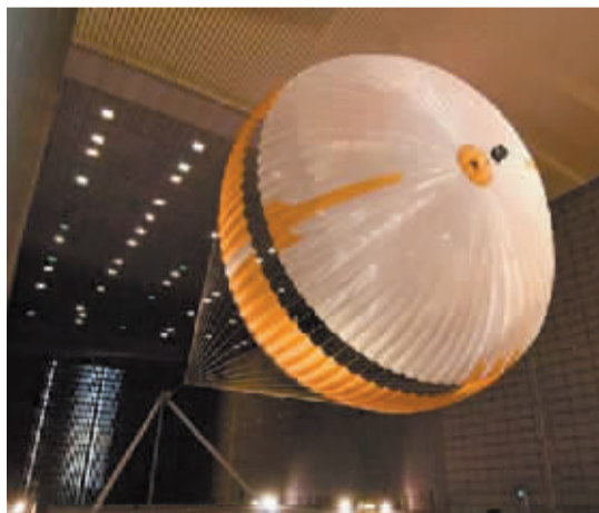
NASA测试的“史上最大降落伞”直径达30米。
