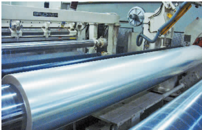
这种看似普通保鲜膜的产品是只有五分之一头发丝粗细的超薄电容膜。
