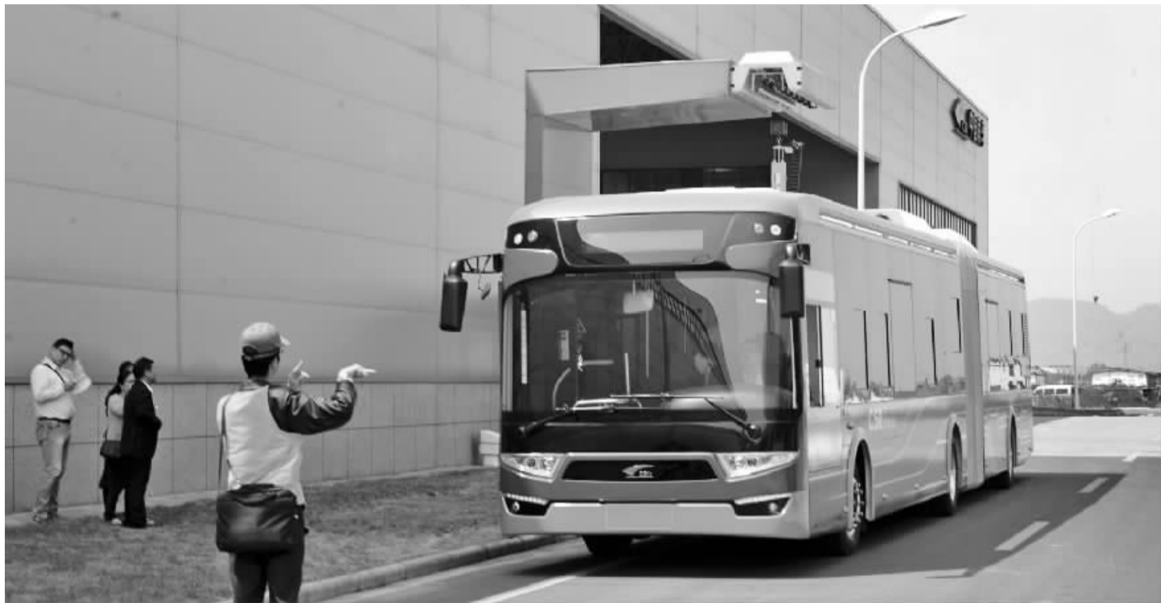
一辆今年4月份下线的超级电容储能式现代电车(资料照片)。 记者 龚国荣 摄
