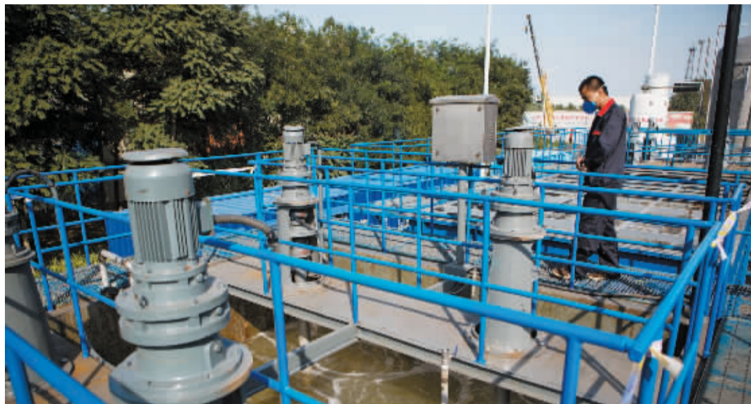
8月27日,天津港“8·12”事故核心区高浓度氰化物处理设备投入使用。图为工作人员在检查氰化物处理设备运行情况。 新华社发
