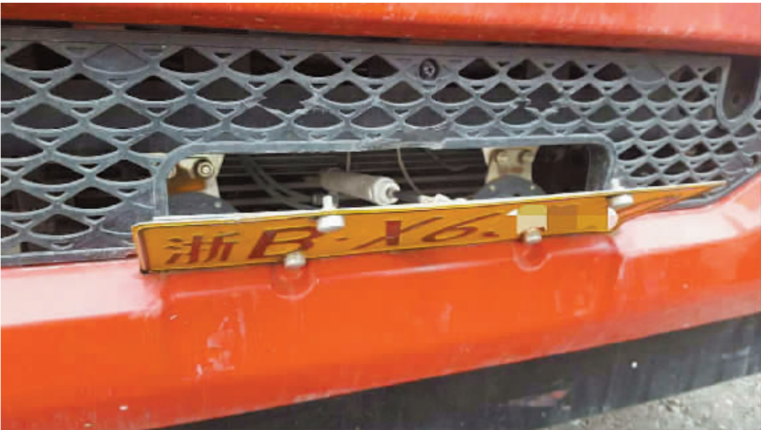
货车安装气压式装置,可实现车牌翻转。通讯员 林静 摄
