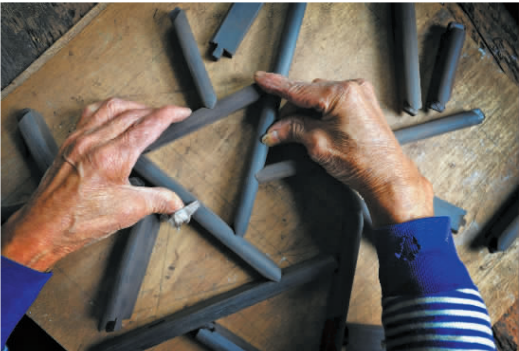
榫卯结构要工艺精准,一有偏差就难以合成。
