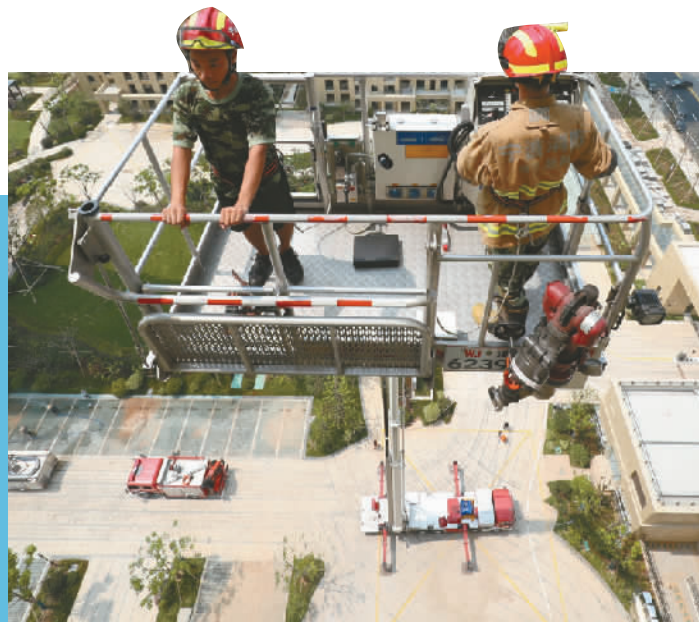
消防官兵利用78米云梯车开展高层建筑火灾救援测试。
