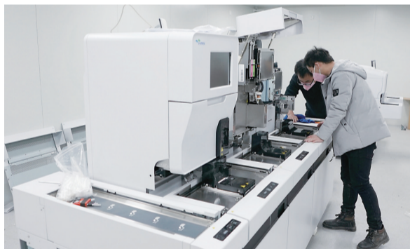
2月5日，技术人员在建设中的武汉雷神山医院内调试尿液分析仪。
