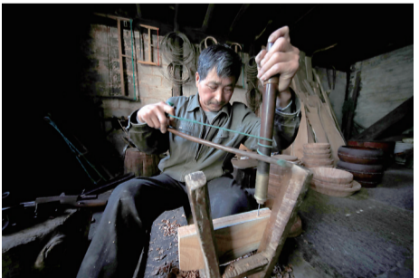
忻定根在用索钻打孔,这件索钻跟随了他50多年。
