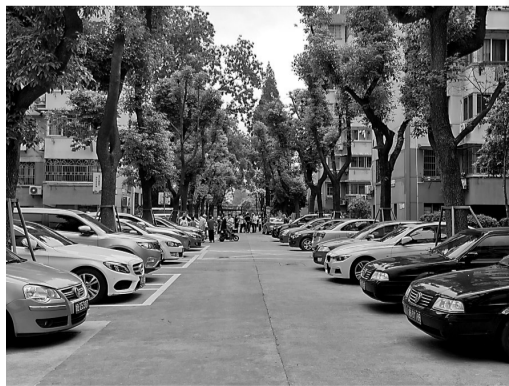
后河小区重新对停车位进行划线，中间留足了4米宽的消防车道。
