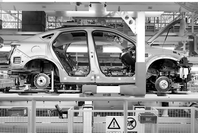
宁波远景汽车零部件有限公司底盘合装流水线。
