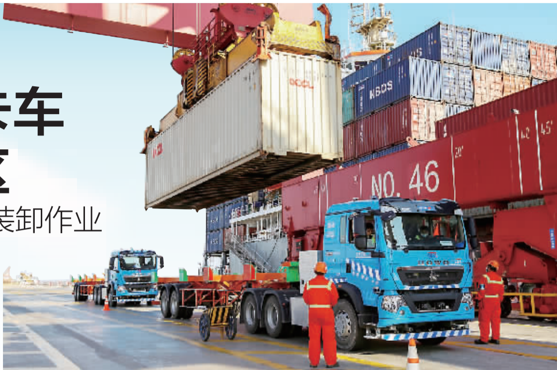
无人驾驶集卡车在作业中,车上人员并不是驾驶员,而是测试时的安全人员。通讯员供图
