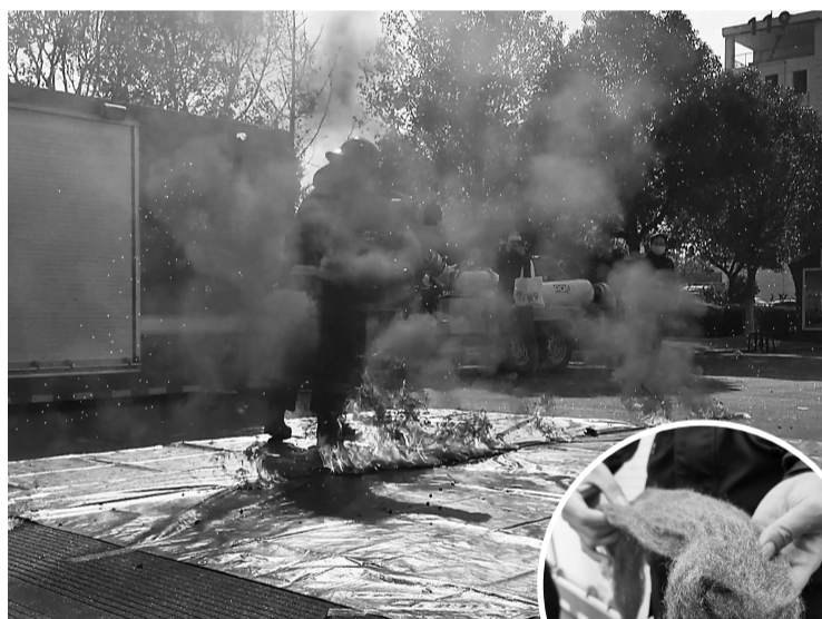
▲钢丝棉上掉落的火球将布垫引燃。 ▶消防实验人员使用的钢丝棉。
