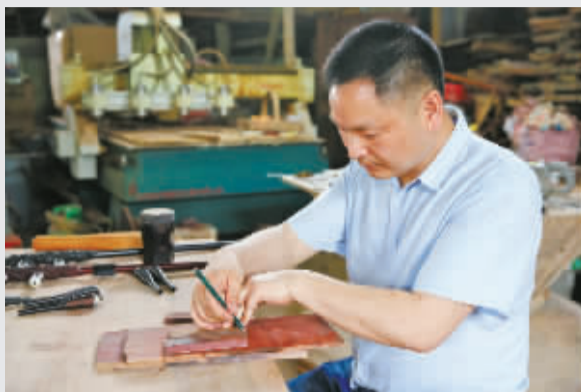
将选取的木料切割成琴筒板。
