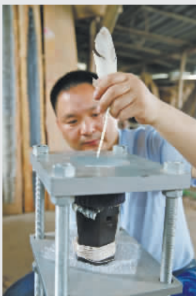
鞣皮时，张福科用鹅毛来敲击琴筒，通过发出的声音来判断鞣皮效果，以便调整松紧。
