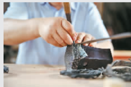
蛇皮蒙在琴筒上后，将多余的边角料切除。
