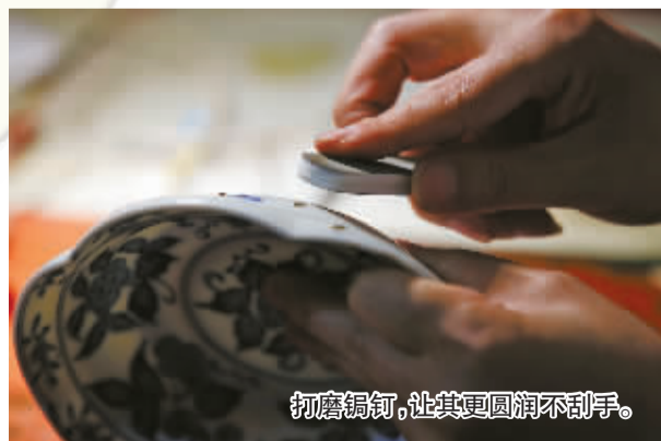
给瓷器钻孔，力道要掌握好，不能将瓷器钻透。
