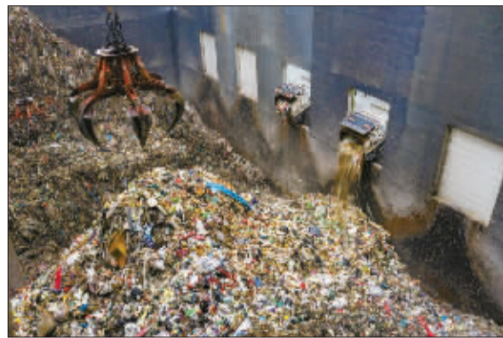
主厂房里一片忙碌,垃圾运输车行至二层卸料大厅进行卸料。
