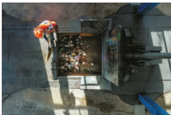
环卫工人对清扫回来的垃圾运至中转站进行压缩打包,再通过垃圾运输车运至焚烧中心。
