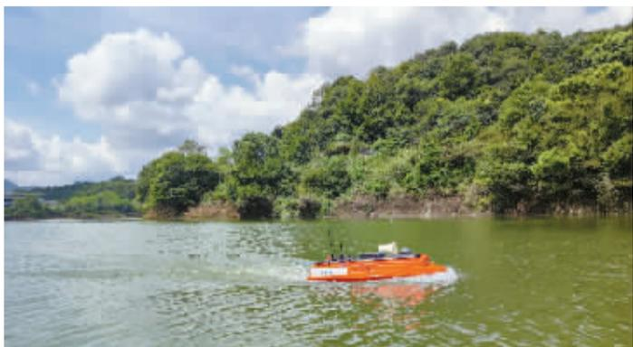
▲水库监测“神器”5G无人船，能凭借搭载的水质信息监测设备，加大巡查覆盖面积，高效分析大面积水质情况，实现智慧水域监控。
