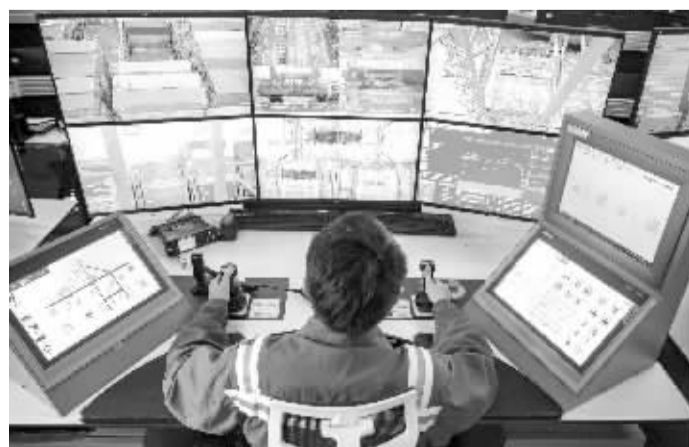
操作装卸集装箱。操作人员在远控桥吊操作室里，远程
