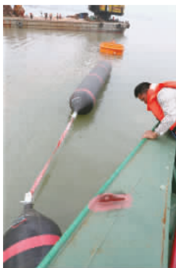
试验船上的工作人员在查看自承载橡胶气囊的拦截效果。
