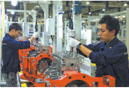
4 月 2 日，长安福特工作人员在进行发动机零部件组装。
