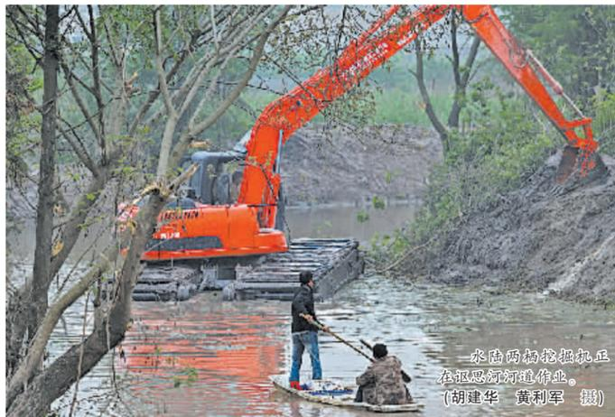
水陆两用挖掘机正在鄞惠河河道作业。(胡建华 黄利军 摄)
