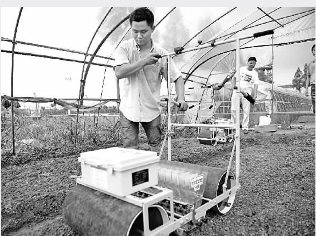
近日，在奉化市绿苑蔬果专业合作社蔬菜大棚里，技术人员正在使用自动播种机播撒鸡毛菜种子。经测试，一垄 40 多米长的地只用了不到 5 分钟就播种完毕。该播种机采用电瓶驱动，操作方便，可根据需要调节株距，能大大提高生产率，降低人工成本。（王红雨 严龙 摄）
