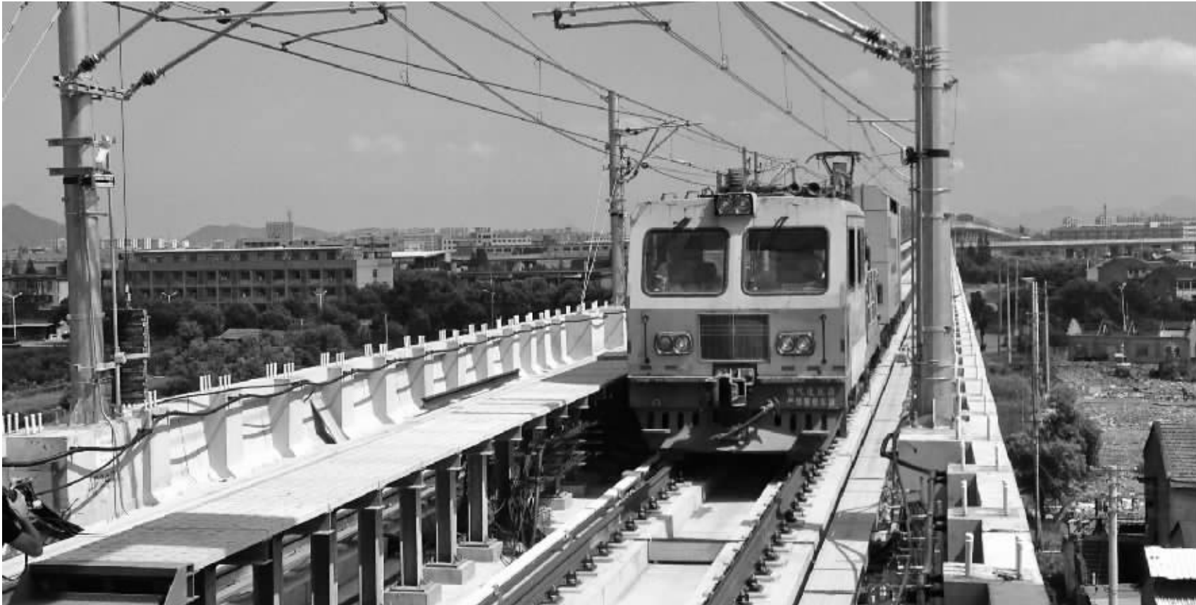
检测车驶出1号线二期工程鄞隘站,进行接触网冷滑测试。记者 房伟 摄
