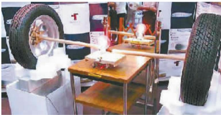
日本丰桥技术科学大学在横滨举办的贸易展上展示这一无线充电技术。研究人员把与日本公共道路相同的混凝土砖块置于展台两边的白色基座中，基座内藏有发电机。两边砖块上各放置一个全尺寸轮胎，两者以电线连接，电线中间还连着一个灯泡。
