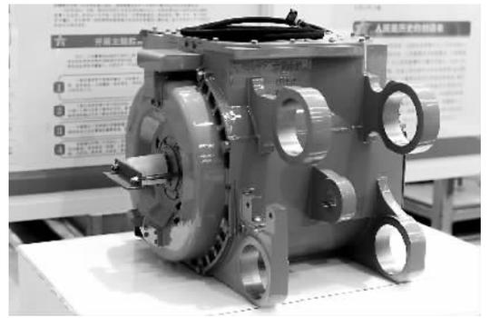
中车株洲电机公司17日发布了时速400公里高速动车组用TQ-800永磁同步牵引电机。这标志着我国高铁动力首次搭建起时速400公里速度等级的永磁牵引电机产品技术平台，填补了国内技术空白，为我国轨道交通牵引传动技术升级换代奠定了坚实基础。
